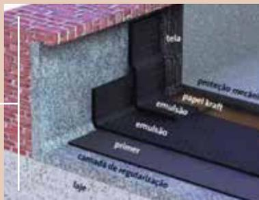
Foto ilustrativa do esquema de impermeabilização de lajes.
